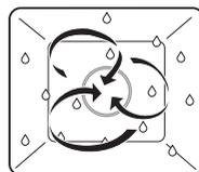
L'aria della camera di cottura viene riscaldata dall'apposito elemento dietro la parete posteriore e circola in modo uniforme. L'umidità propria generata dagli alimenti viene espulsa in misura minima dalla camera di cottura. L'umidità dell'alimento viene preservata.
