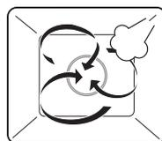
La camera di cottura viene riscaldata con l'aria calda. L'aggiunta di vapore fa sì che l'energia venga trasmessa all'alimento in modo più efficiente. Il processo di cottura è pertanto più veloce e l'alimento diventa particolarmente croccante.
