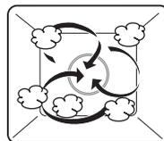
La camera di cottura viene riscaldata contemporaneamente con vapore e aria calda. L'alimento viene riscaldata e portato a cottura con il vapore.
