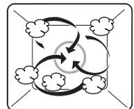
La camera di cottura viene riscaldata contemporaneamente con vapore e aria calda. L'alimento viene riscaldato e portato a cottura con il vapore.
